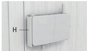
**1.** Calcolare in quale posizione si desidera installare la serratura, sempre all'interno della porta. Posizionare il distanziatore adesivo (H) come mostrato nell'immagine, attaccato al corpo della serratura.
