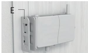
**2.** Platzieren Sie den Bolzenhalter (E) neben dem Klebeabstandhalter (H) am Türrahmen. Der Abstandshalter zeigt den Mindestabstand zwischen dem Schloss und dem Bolzenhalter an. Wenn die beiden Teile nicht auf der gleichen Höhe sind, müssen Sie in Schritt 4 die Unterlegscheiben (C) verwenden, um das Schloss zu unterlegen.
