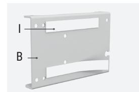
**3.** Coller les bandes adhésives (I) à l'arrière du cadre de la serrure (B) ou sur les sous-pans (C), afin de positionner correctement la serrure sur la porte avant le perçage.
