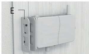
**2.** Al lado del distanciador adhesivo (H) coloque el alojamiento de bulones (E) sobre el marco de la puerta. El distanciador le marca la separación mínima entre la cerradura y el alojamiento de bulones. Si ambos no están a la misma altura, deberá utilizar las piezas (C) para calzar la cerradura en el paso 4.
