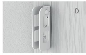
**7.B** Vergewissern Sie sich, dass der Magnet (D) vor den Bolzen positioniert ist.
