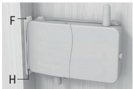
**2.** Platzieren Sie die Blende (F) neben dem Klebeabstandhalter (H) am Türrahmen. Der Abstandhalter zeigt den Mindestabstand zwischen dem Schloss und der Blende an. Wenn die beiden Teile nicht auf der gleichen Höhe sind, müssen Sie in Schritt 4 die Unterlegscheiben (C) verwenden, um das Schloss zu unterlegen.
