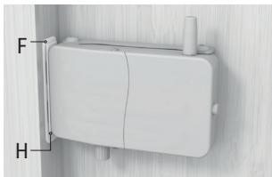
**2.** Ao lado do separador adesivo (H), coloque o acabamento (F) sobre o aro da porta. O separador marca a separação mínima entre a fechadura e o acabamento. Caso ambos não estejam à mesma altura, deverá utilizar as peças (C) e (D) para aplicar um calço na fechadura, no passo 4.
