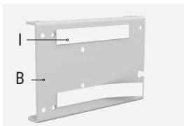
**3.** Bringen Sie die Klebestreifen (I) an der Rückseite der Basisplatte (B) oder an den Unterlegscheiben (C) an, um sie vor dem Bohren richtig an der Tür zu positionieren.
