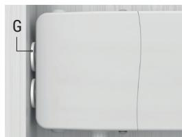
**6.** Retire o separador adesivo. Coloque os discos adesivos (G) nas trancas da fechadura.
