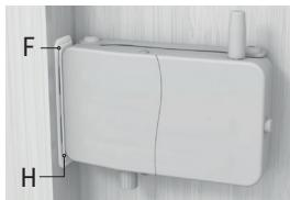
**2.** À côté du distanciateur adhésif (H) placez la plaque de la gâche (F) sur le cadre de la porte. Le distanciateur indique la distance minimale entre la serrure et la gâche. Si les deux ne sont pas sur la même hauteur/profondeur, vous devez utiliser les sous-pans (C) afin d'ajuster la serrure lors de l'étape 4.
