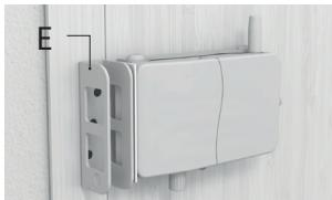
**2.** À côté du distanciateur adhésif (H) placez le cadre de la gâche (E) sur le cadre de la porte. Le distanciateur indique la distance minimale entre la serrure et la gâche. Si les deux ne sont sur la même hauteur/profondeur, vous devez utiliser les sous-pans (C) afin d'ajuster la serrure lors de l'étape 4.
