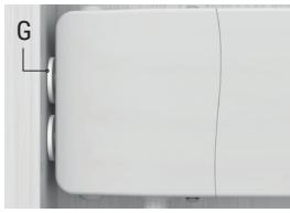
**6.** Rimuovere il distanziatore adesivo. Posizionare i dischi adesivi (G) sui bulloni della serratura.
