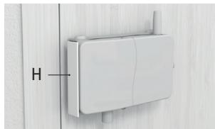
**1.** Calcule en qué posición quiere instalar la cerradura, siempre por el interior de la puerta. Coloque el distanciador adhesivo (H) según muestra la imagen, pegado al cuerpo del cerrojo.
