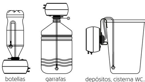
No se necesitan herramientas para realizar la instalación. Únicamente usaremos un cutter para cortar los tramos de tubería.
