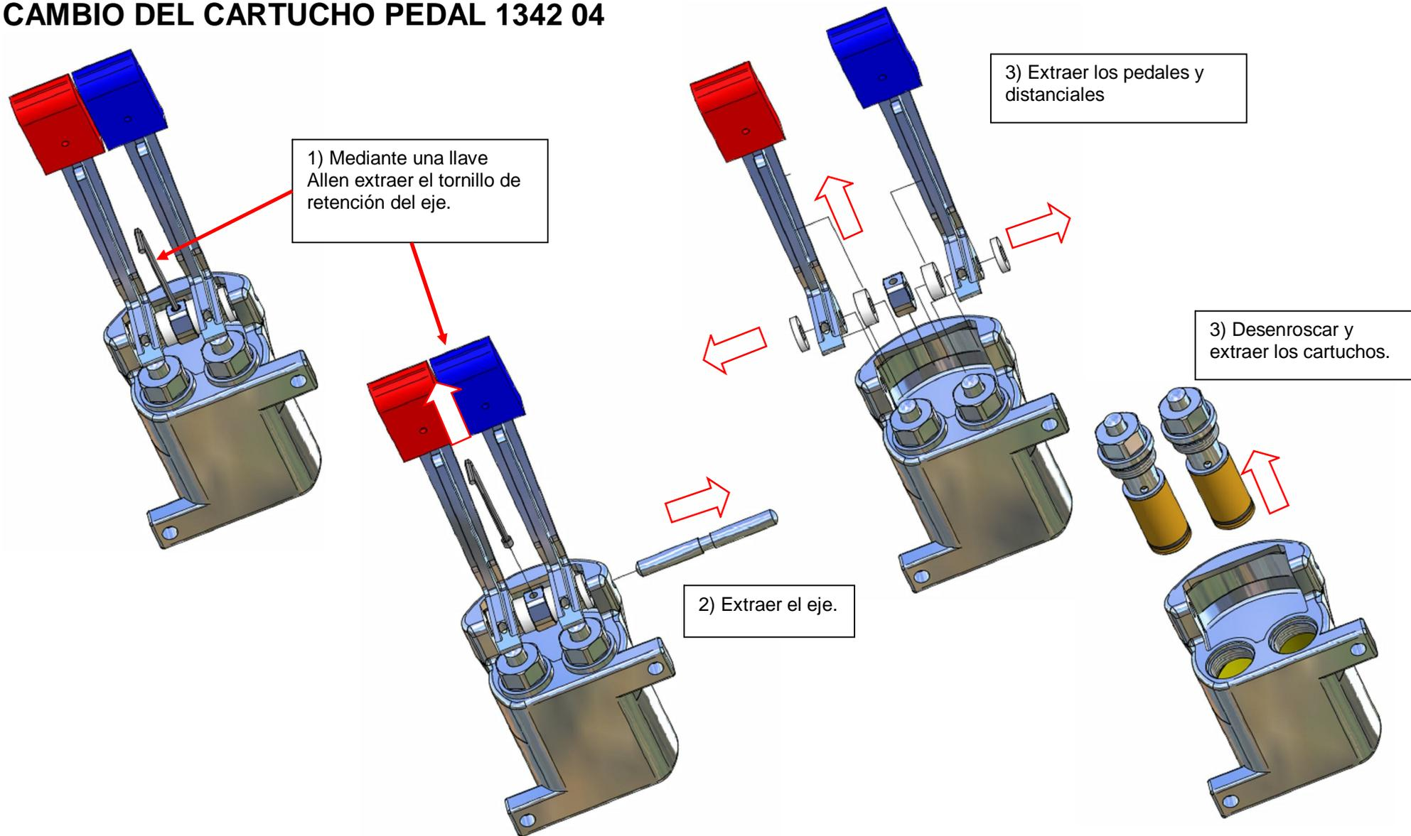
**Atención:** Para volver a montar el cartucho, repetir todos los pasos a la inversa, comprobar que el cartucho quede bien roscado y que el pedal no presione sobre el eje del cartucho.
