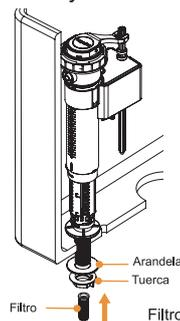
Filtro fácilmente desmontable para limpiar impurezas.
