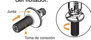
3 Montar el flotador en el depósito utilizando la arandela y la tuerca.
